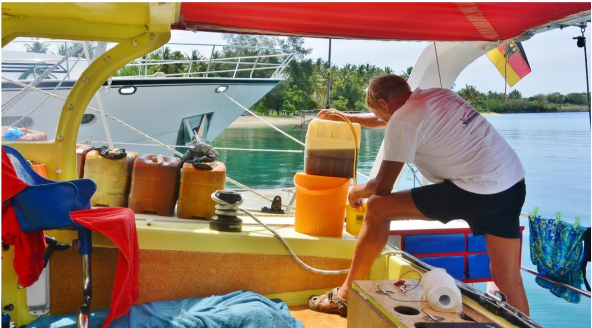
Verwendung eines eigenen Filters um Dreck und etwaiges Wasser abzuscheiden.
